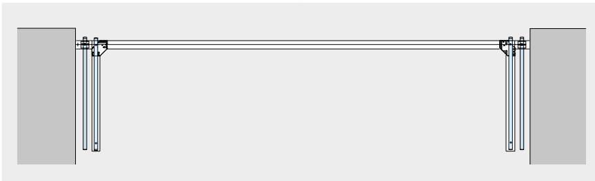
Parken mit je einem Parkschenkel für Schiebeflügel vor den Drehendflügel, einseitig oder beidseitig öffnend, beiderseits der Anlage (2 Dreh-Endflügel/2 Schiebeflügel).
